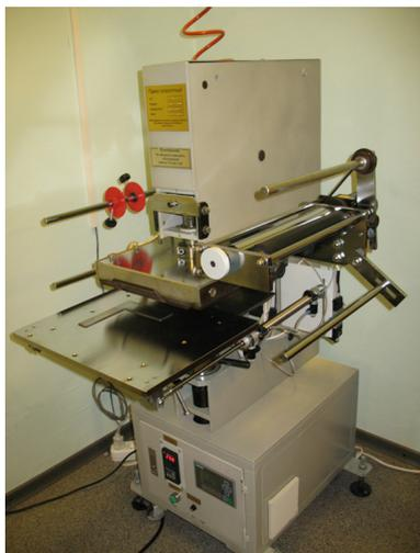
WT3-19 Пресс горячего тиснения с пневматическим приводом. Используется для различных видов тиснения: блинтового, конгревного, а также для малоразмерной вырубки. Обладает такими регулируемыми параметрами, как время прижима и автоматическая протяжка фольги, температура нагрева, скорость движения плиты. Выдвижной стол с упором для заготовок.
